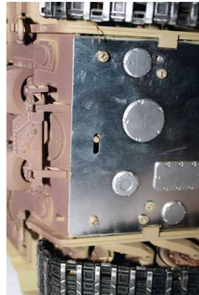
Gut zugänglich sind die Verriegelung der Oberwanne und die beiden Stellschrauben für die Kettenspanner-Schrauben
